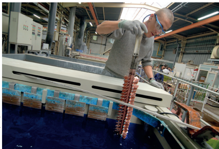
Trempe de pièces dans un bain de pyrophosphate de cuivre.
