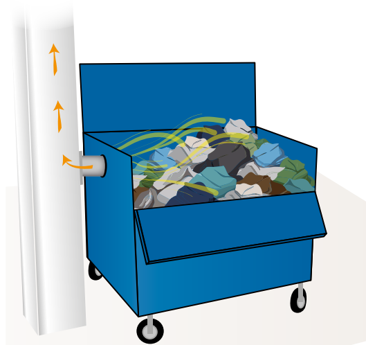
■ Figure 9 : Container à déchets ventilé
