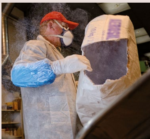
◀ Figure 10. Chargement d'un réacteur lors de la formulation d'une colle
