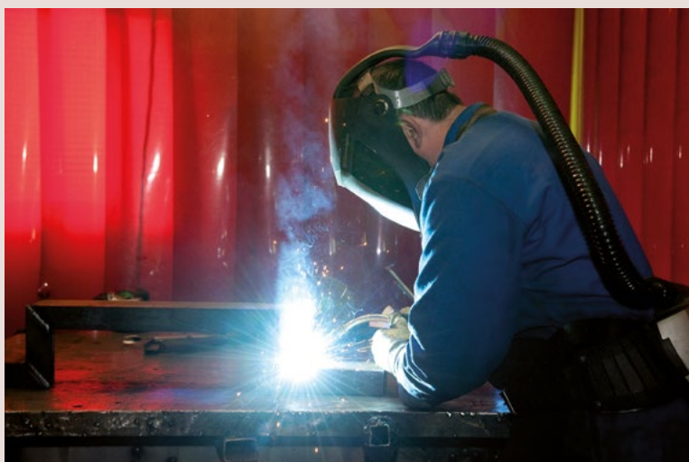
◀ Figure 11. Opération de soudage à l'arc
