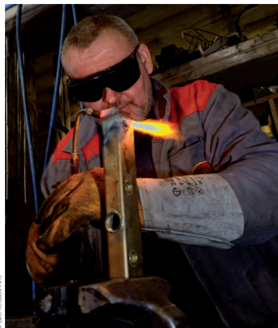
Figure 9. Opération de soudage à la flamme
