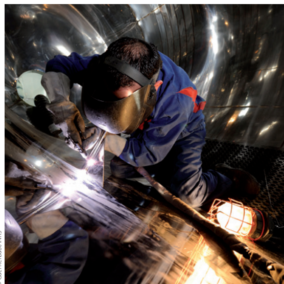
Figure 15. Opération de soudage à l'arc sous protection gazeuse avec électrode réfractaire
