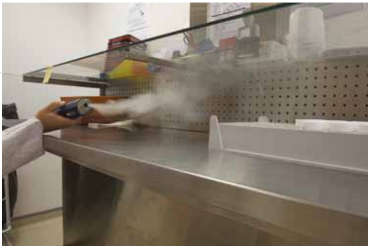
Test au fumigène sur la table de réception
