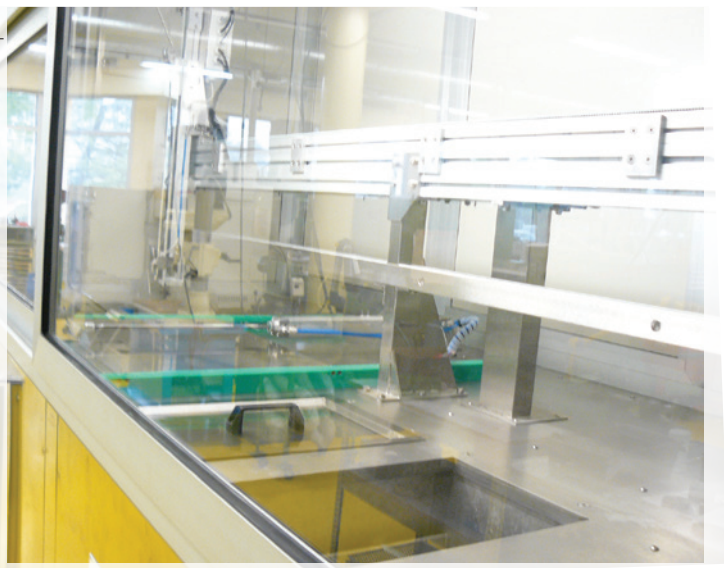
Photo 14 • Machine à cuves ouvertes capotée
