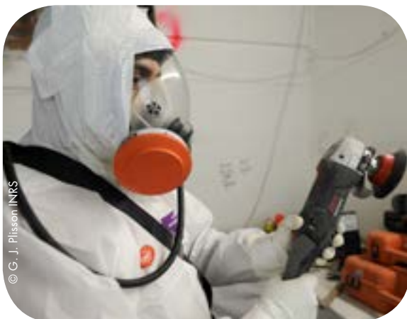
Ponceuse avec captage à la source intégré
