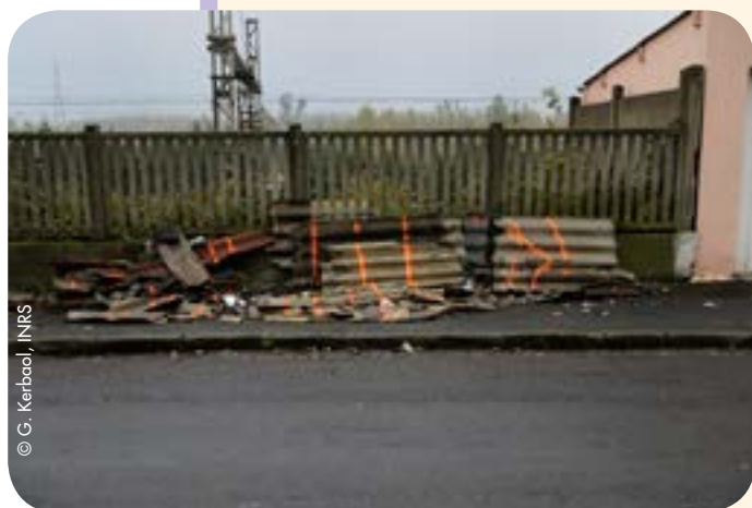
Dépôt sauvage d'amiante
