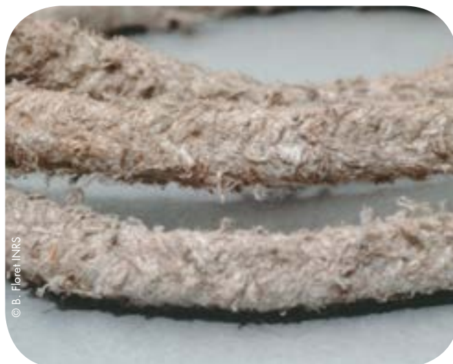
Joint tresse en amiante
