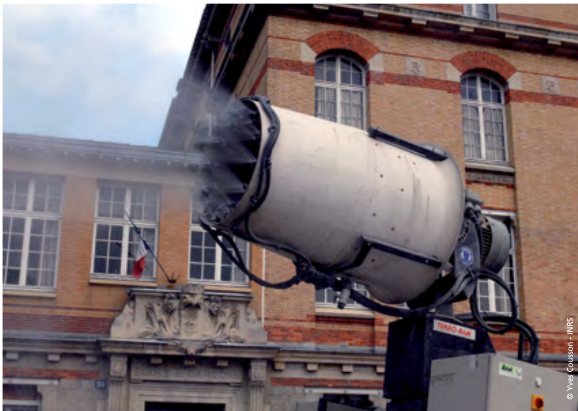
Brumisation au sol avec un système de propulsion par ventilateur
