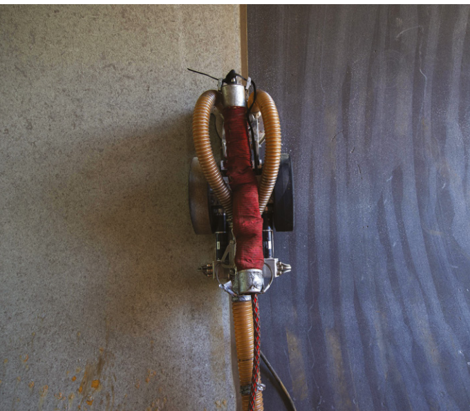
Robot d'enlèvement de peinture par ultra haute pression.
