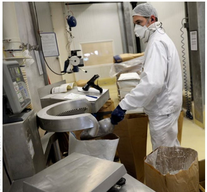
■ Poste de chargement manuel de poudres muni d'un demi-anneau aspirant
