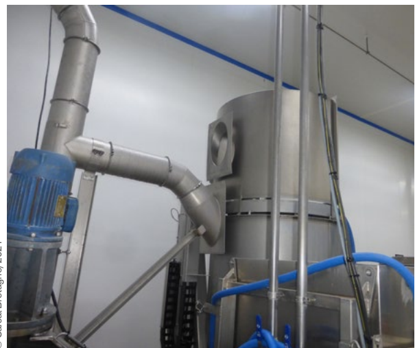
■ Caisson et cuve de mélange en position haute lors de la vidange dans les bacs
