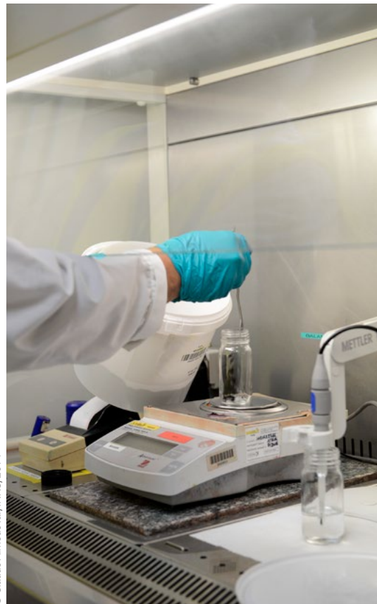
■ Pesée de petites quantités de poudre dans une sorbonne de laboratoire
