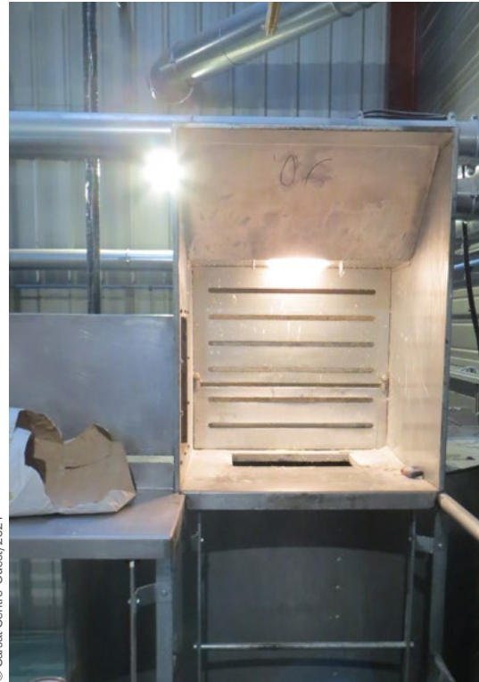
■ Caisson aspirant encoffrant la trappe de remplissage
