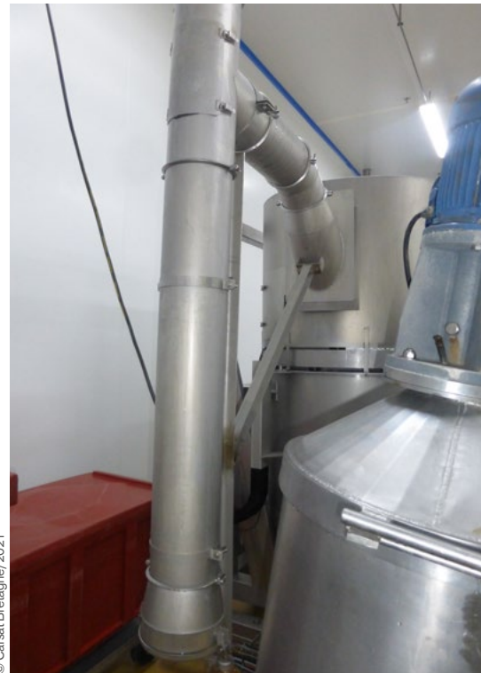
■ Arrière du caisson avec trappe et système de récupération des poussières pour faciliter le nettoyage et limiter les risques de contamination croisée
