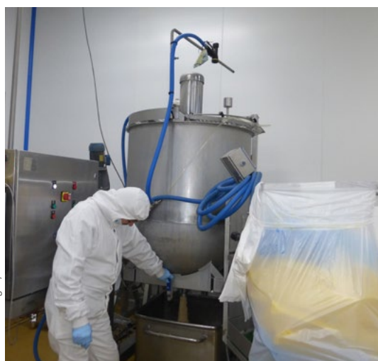
■ Vidange de la cuve en position haute
