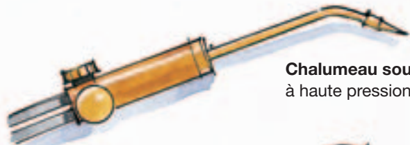
Chalumeau soudeur et chauffeur à haute et basse pression avec aspiration.
