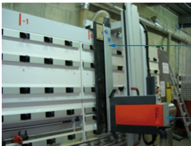
Captage par lèvre aspirante sur l'émission secondaire
