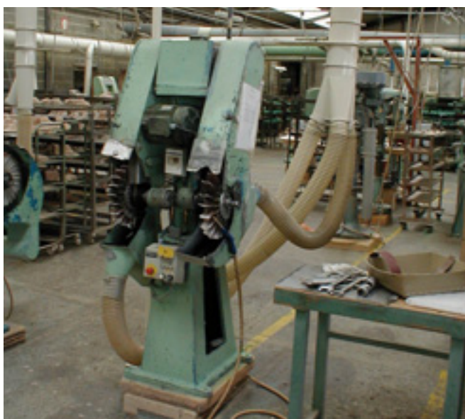
PONCEUSE (AVANT) Le dispositif de captage d'origine qui équipe cette ponceuse ne tient pas compte du sens d'éjection des poussières et des particularités des pièces à poncer. De plus, le dispositif de captage n'est pas suffisamment au niveau des brosses et le débit de 1 900 m 3 /h est insuffisant. Il en résulte un empoussièrément au niveau de l'opérateur d'environ 6 mg/m 3 .
