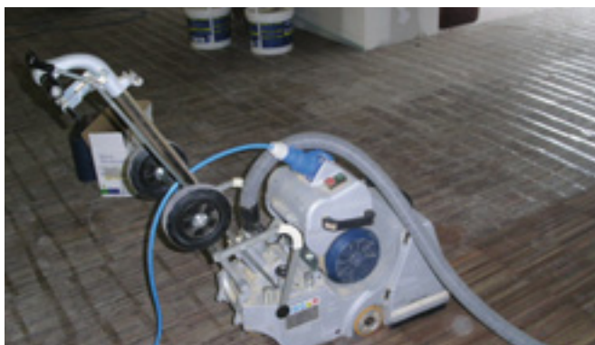
Ponceuse avec dispositif de captage des poussières.
