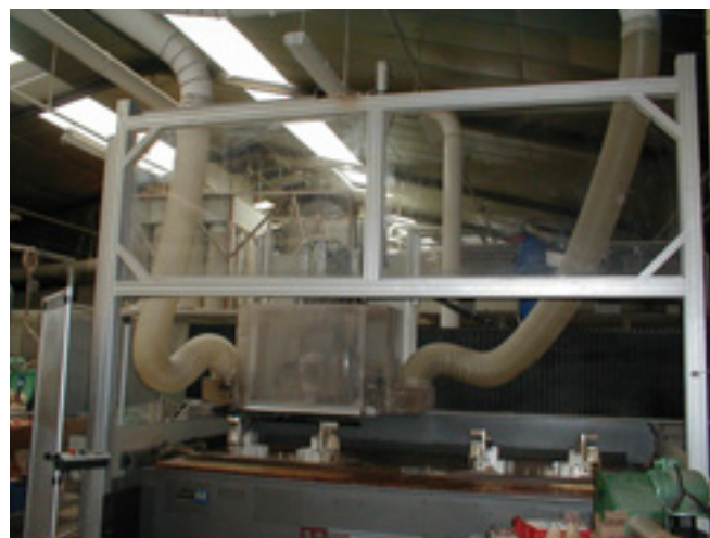
CENTRE D'USINAGE (APRÈS) Deux capteurs ont été installés au plus près des outils de coupe et d'autres capteurs ont été installés sur la table où sont fixées les pièces à usiner. L'optimisation de la forme et de la position des capteurs a permis de réduire le débit d'aspiration à 5 100 m 3 /h tout en réduisant l'empoussièrément à 0,4 mg/m 3 .
