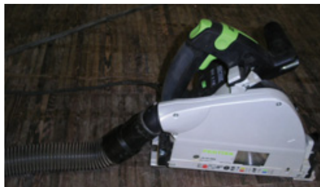
Scie avec dispositif de captage des poussières.
