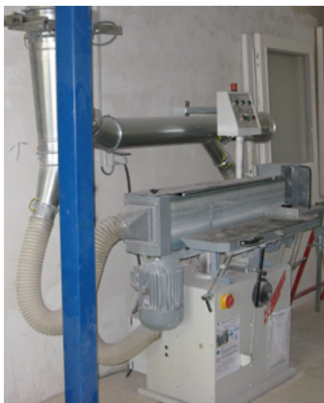
Ponceuse horizontale avec captages sur les têtes de bande.
