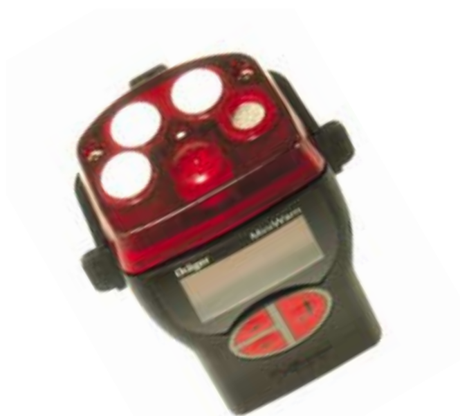
Figure 4. Détecteur multi-gaz MiniWARN Draeger : 3 capteurs électrochimiques, 1 capteur catalytique, 1 capteur infra-rouge.
