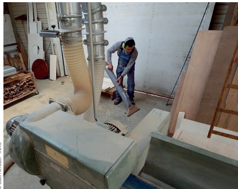
■ Nettoyage d'un atelier par aspiration
