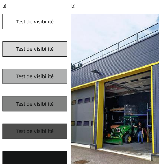
FIGURE 16 Lien entre le contraste de luminance et la visibilité d'un objet. Lorsqu'un objet a la même luminance que le fond sur lequel il doit apparaître, sa visibilité devient nulle. a) Affichage d'un texte en noir sur un fond de niveau de gris variable. b) Difficulté à percevoir l'environnement intérieur depuis l'extérieur : risque accru de collision engin-piéton.
