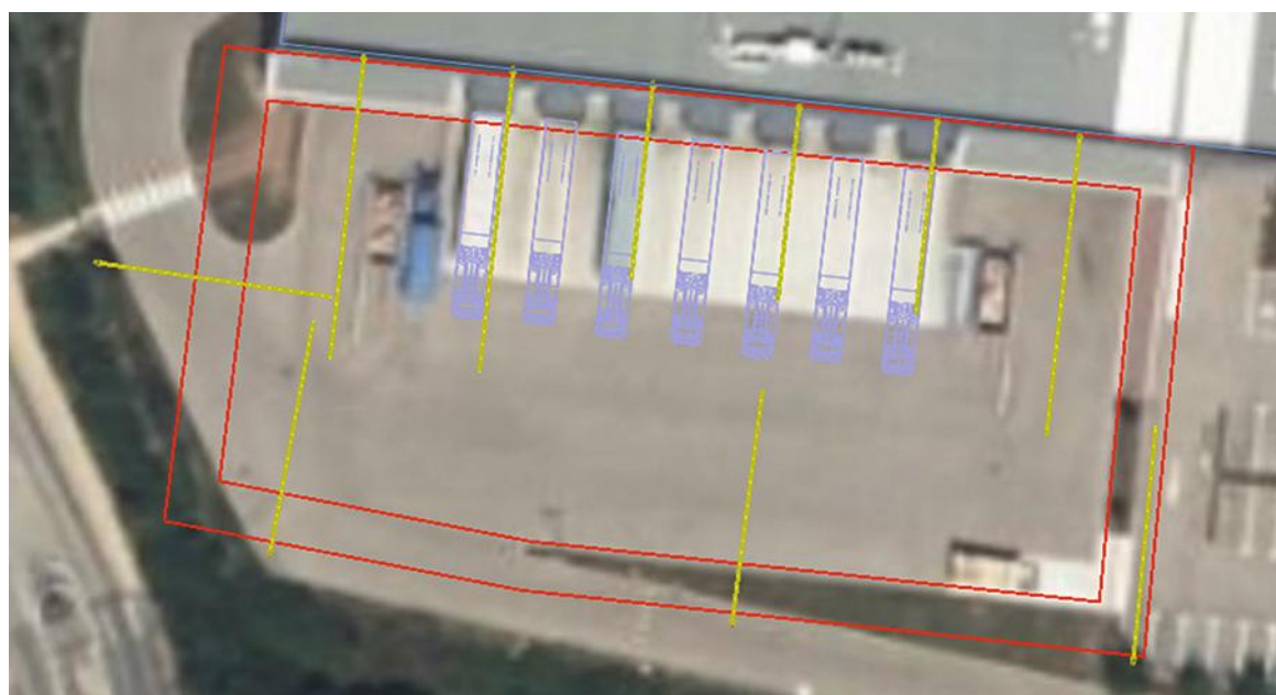
FIGURE 18 → Ajout de luminaires complémentaires (traits jaunes) pour éclairer la zone environnante (traits rouges) (logiciel utilisé : ReluxDesktop).
