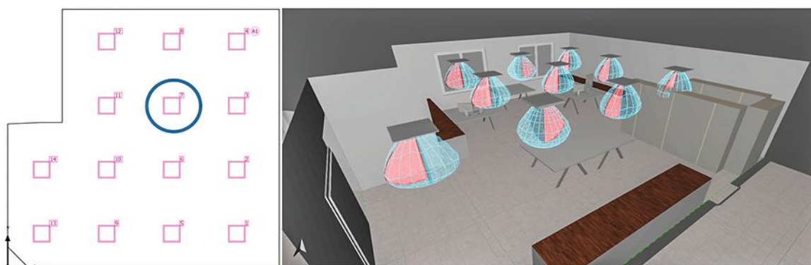
↑ FIGURE 6 Postes de CAO en open space (catégorie 34.4 de la norme NF EN 12464-1). Le luminaire entouré est doté d'une cellule photosensible pour limiter la consommation énergétique de l'installation, en modulant son flux lumineux pour compléter l'éclairage naturel. Ci-dessous : vue en 3D du local, faisant apparaître la distribution lumineuse des luminaires (logiciel utilisé : ReluxDesktop).
