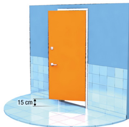
■ Figure 10.2 – Bas de porte à 15 cm du sol pour faciliter le nettoyage.
