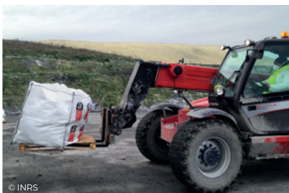
Déchargement d'un GRV sur palette à l'aide d'un engin de levage
