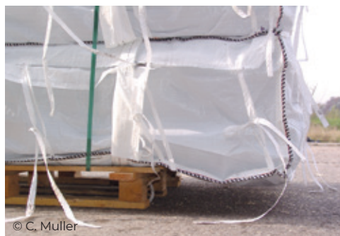
La disposition 168 ne s'applique pas car la longueur de la palette est inférieure à celle des plaques d'amiante-ciment
