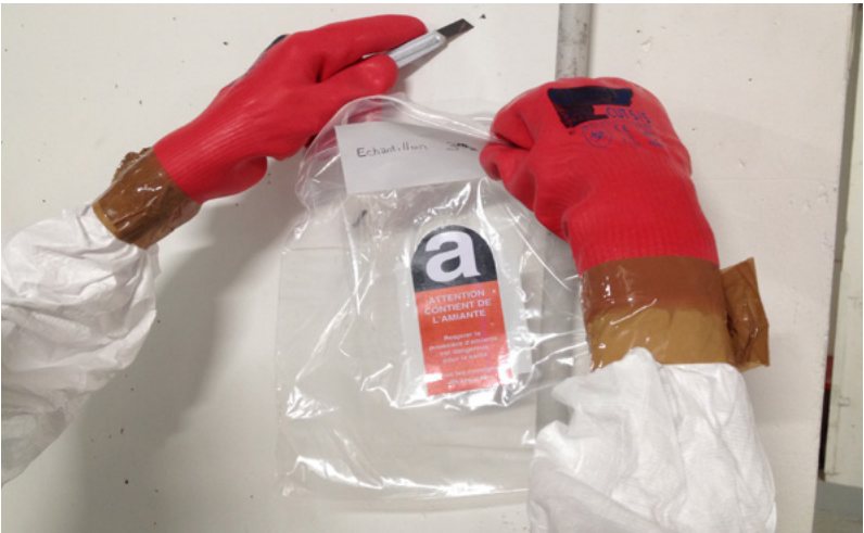
Figure 6 - Prélèvement d'enduit susceptible de contenir de l'amiante
