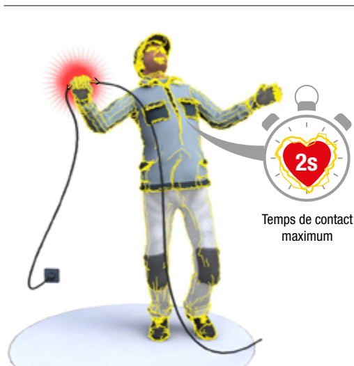
FIGURE 10. Le temps de passage du courant dans le corps humain : un facteur important. Par exemple, au delà de 2 s, un courant de 10 mA est dangereux.
