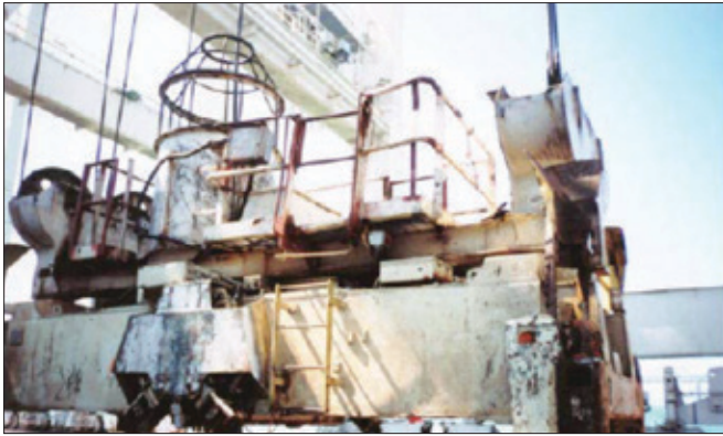
Plataforma para elevar personal con portón de acceso en mitad superior de la baranda
