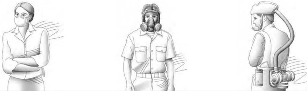
Los trabajadores que se ilustran arriba están usando un respirador con mascarilla de filtrado N95 aprobado por NIOSH (izquierda), un respirador elastomérico de cara completa (centro) y un respirador purificador de aire forzado (PAPR) de ajuste holgado (derecha).
