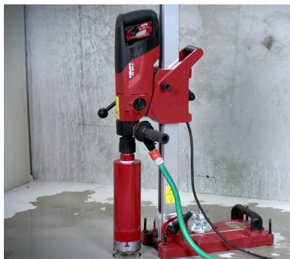
Un taladro perforador montado en la plataforma con un sistema integrado de suministro de agua.
