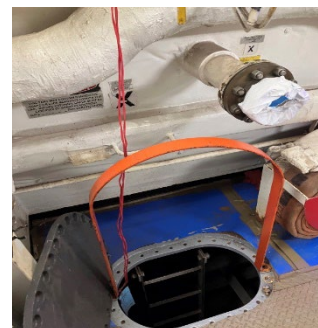
(Izquierdo) La imagen muestra una cubierta de escotilla con una cobertura adecuada. (Lado derecho) La imagen muestra el uso apropiado de una barra en forma de "U" para proteger temporalmente las alcantarillas empotradas durante las operaciones de construcción y reparación de barcos.
