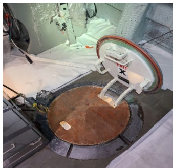
(Izquierdo) La imagen muestra una cubierta de escotilla con una cobertura adecuada. (Lado derecho) La imagen muestra el uso apropiado de una barra en forma de "U" para proteger temporalmente las alcantarillas empotradas durante las operaciones de construcción y reparación de barcos.
