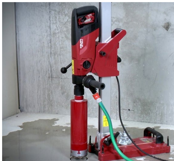
Uma furadeira fixa montada em base com um sistema integrado de fornecimento de água.
