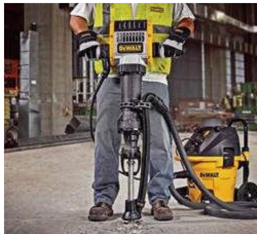
Martillo neumático equipado con VDCS. La cubierta del martillo se conecta a la aspiradora de la derecha.
